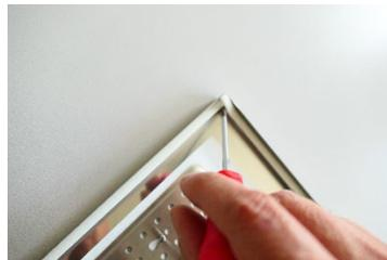
Prüfen Sie nach dem Entfernen der alten Dichtung, ob die Dichtfläche des Deckels beschädigt oder verunreinigt ist. Reinigen Sie den Deckel gegebenenfalls, bevor Sie die neue Dichtung einsetzen.
